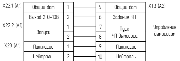
Подключение управления шиберам для варианта МГ-ГБЛ-Н с частотным преобразователем (ЧП) двигателя дымососа
